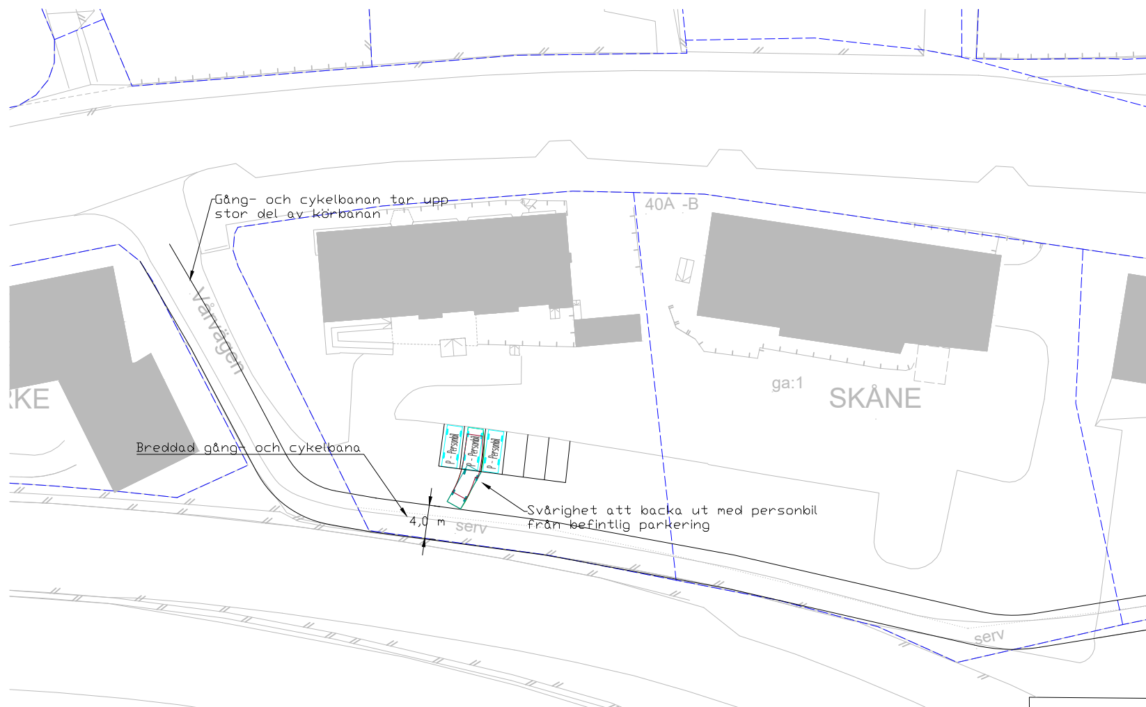
Figur 25 Skissat förslag på en breddning av befintlig gång- och cykelbana utmed Värvägen. Alternativet medför flera negativa konsekvenser.
